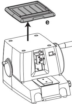
**ALWAYS APPLY THE HANDWHEEL BRAKE BEFORE THE COVER IS REMOVED**
